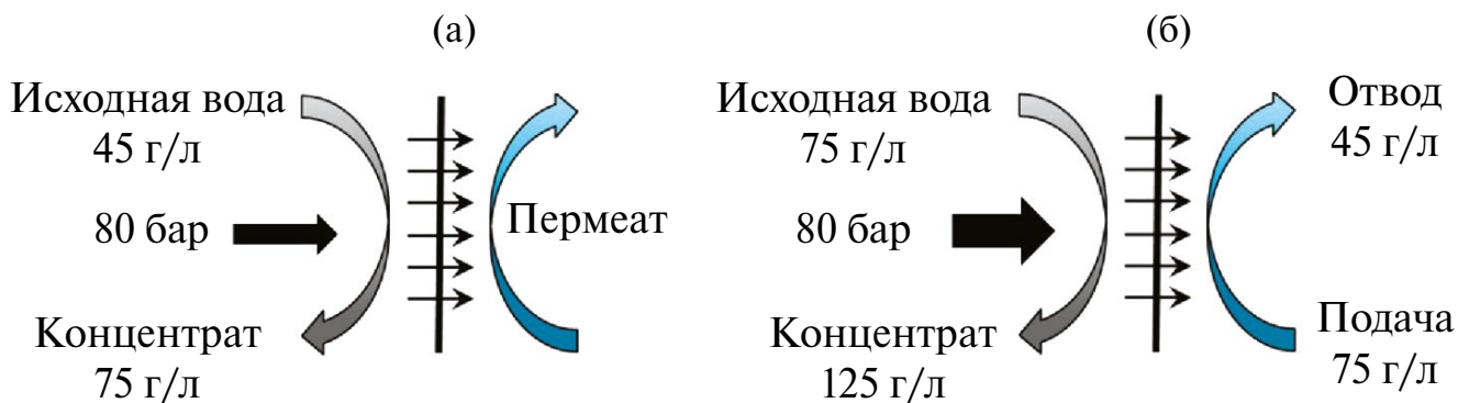
Рис. 3. Иллюстрация механизма обратного осмоса (а) и обратного осмоса с осмотической поддержкой (б).
